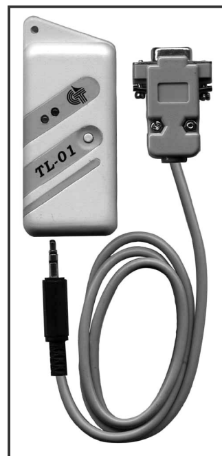
Рис. 1. Внешний вид автономного регистратора температуры и кабеля адаптера.
