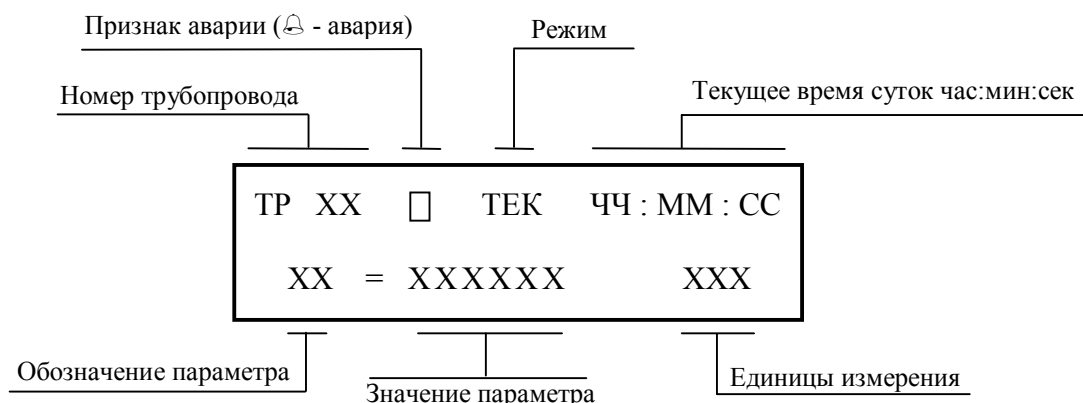
Рис.2.3. Назначение знакомест индикатора пульта оператора в режиме отображения текущих значений
