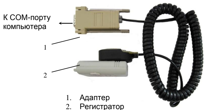
Рис.2. Схема подключения регистратора к компьютеру
